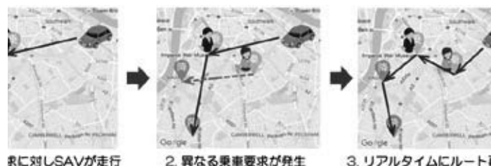
図1. SAVSにおけるルート変更による乗り合いの概念図
